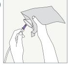
Öffnen Sie den Konusbeutel. Verbinden Sie den Konus mit dem Anschluss des Wasserbehälters, während sich der Konus noch im Beutel befindet, um das System zusammenzubauen.
