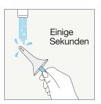
Halten Sie den Konus unter den Wasserstrahl des Wasserhahns oder tauchen Sie diesen für einige Sekunden in Wasser, um die hydrophile Beschichtung zu aktivieren.
