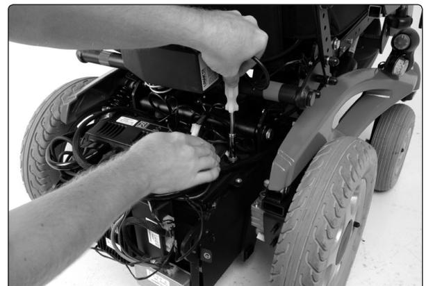
Trennen Sie die Batterieanschlüsse der hinteren Batterie.
