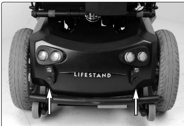
Die Abdeckung ist mit zwei Riegeln gesichert.
