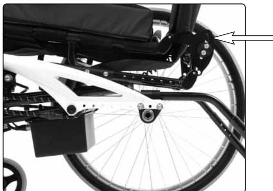
*Der Rückenlehnenwinkel wird mit zwei Schrauben an der linken bzw. rechten Seite fixiert.*
