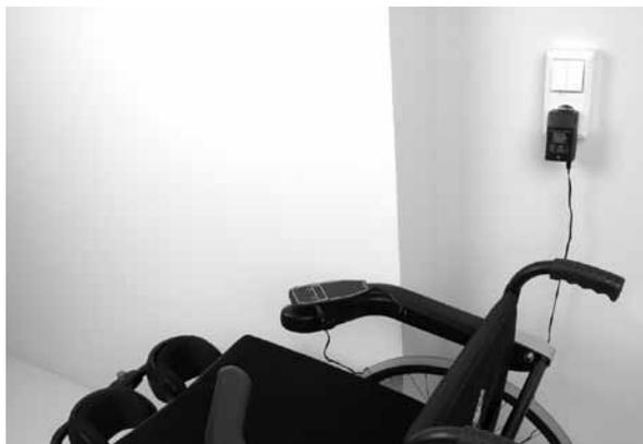
*Kabel des Ladegeräts an das Steuerpult anschließen.*
