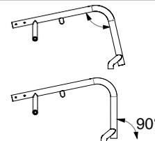
Rahmenwinkel 90° zum Boden
