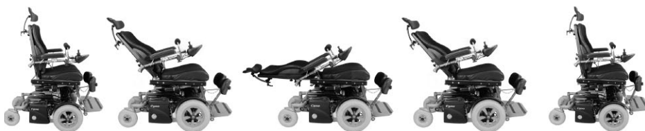
Bewegung des Sitzes bei Einstellung des Rückenlehnenwinkels.
