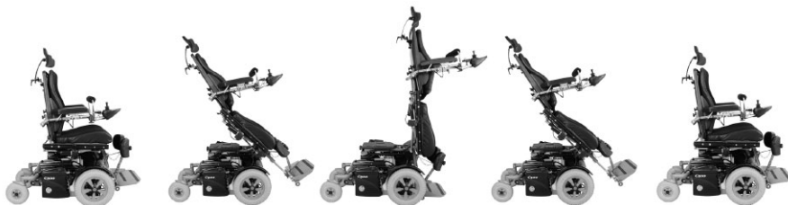
Bewegungsabfolge des Sitzes in aufrecht stehende Position und wieder zurück in sitzende Stellung mit einem Bewegungsmuster, das die Belastung der Knie verringert.
