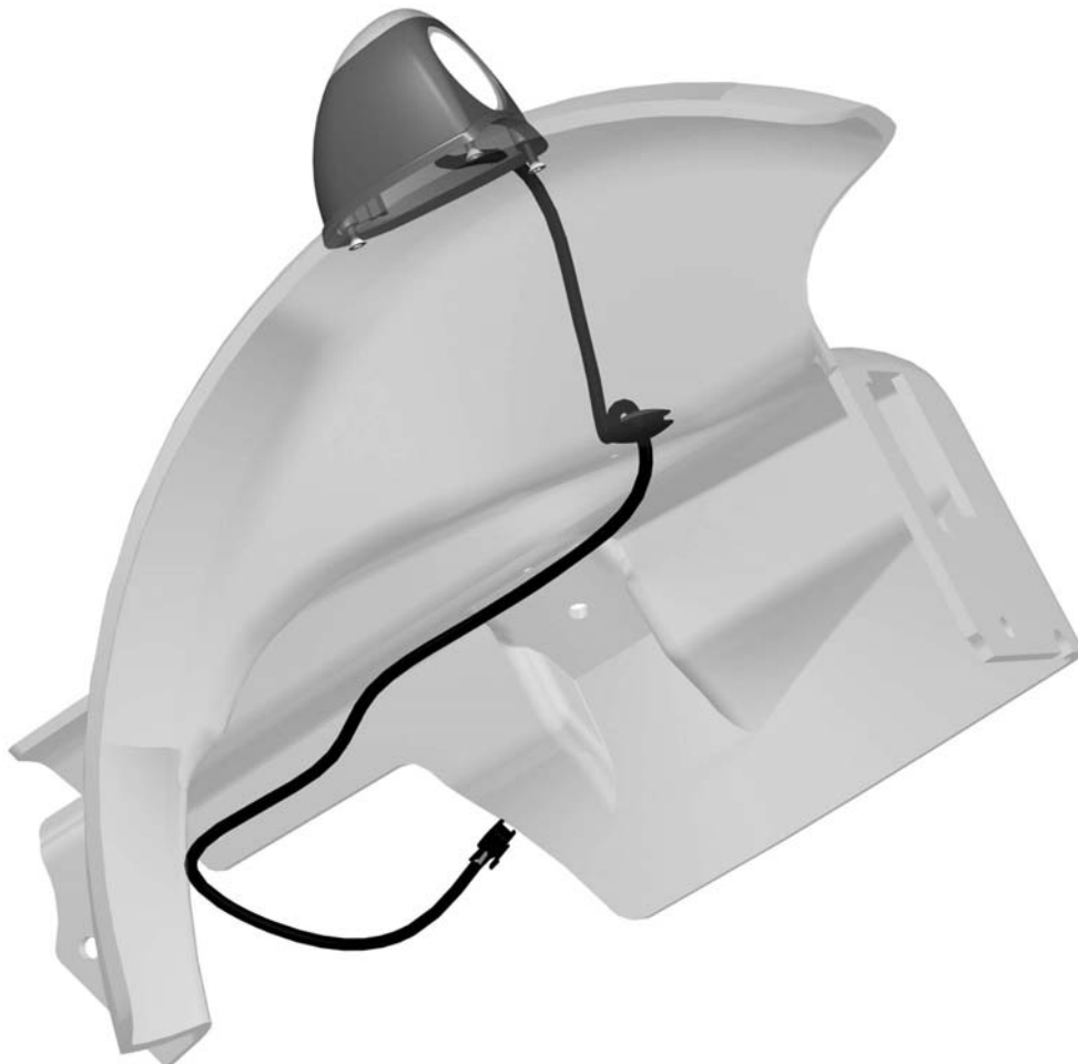
Die vordere Beleuchtung ist mit drei Schrauben befestigt.
