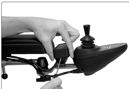
Demontage des Deckels des Schaltkastens.
