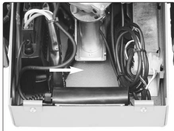
Darauf achten, dass keine Kabel im Bereich unter der Sitzhöhenverstellung beim Antriebsriemen der Sitzhöhenverstellung liegen.
