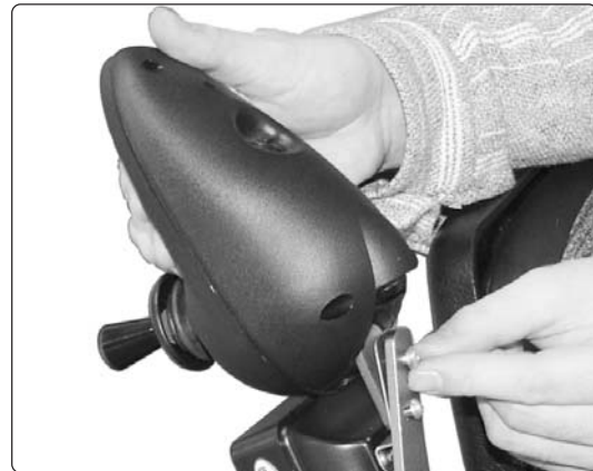
Halterung der Steuerung und des Schaltkastens.
