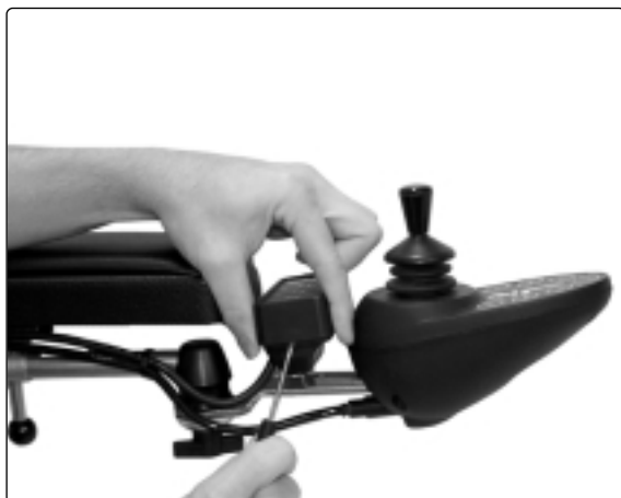
Abb. 44. Deckel des Knopfkastens abnehmen.
