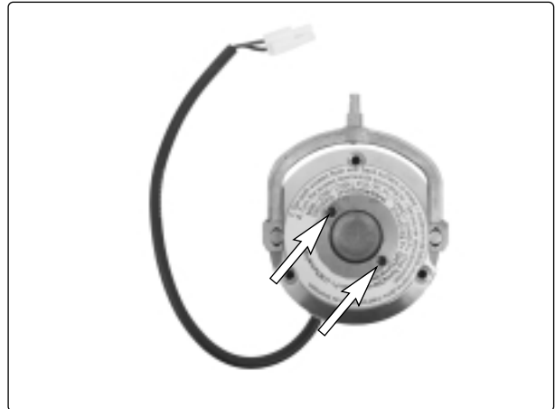
Abb. 20. Bremseinstellung anhand der beiden Einstellschrauben justieren.
