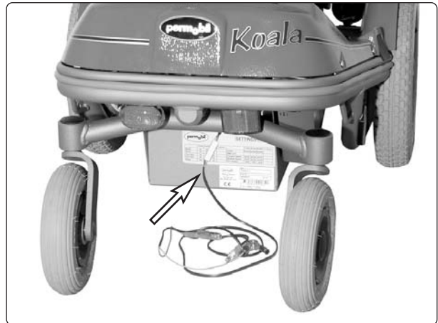
Abb. 4. Anschluss des Kabels für Notbetätigung.
