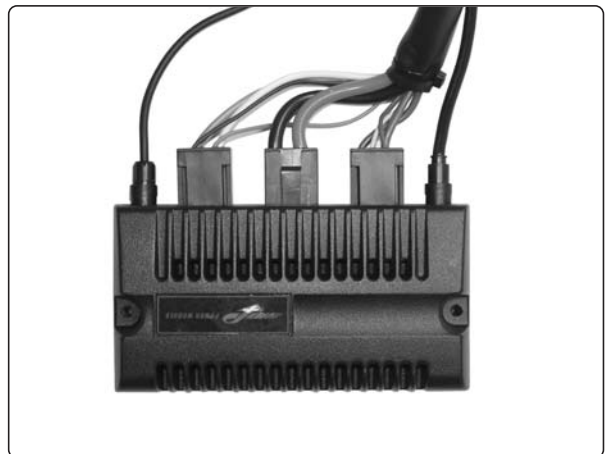
Abb. 44. Anschlüsse Ausgangsstufe Pilot+.
