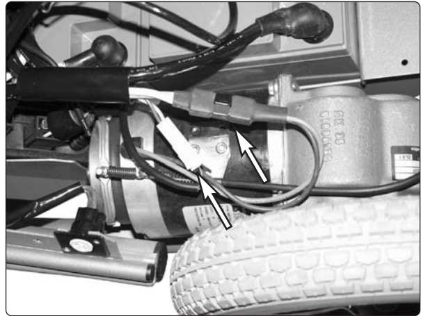
Abb. 19. Anschlusskabel Magnetbremse und Antriebsmotor.
