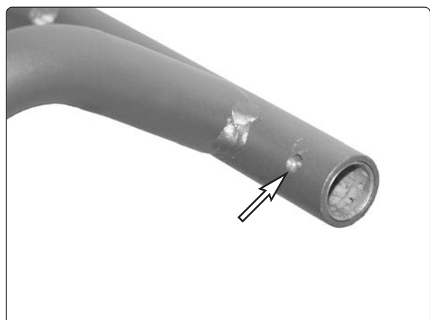
Abb. 41. Loch zur Lagerdeformierung.
