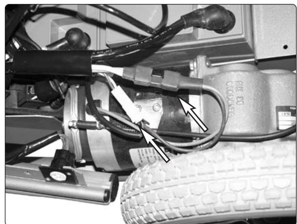
Abb. 29. Anschlusskabel Magnetbremse und Antriebsmotor.
