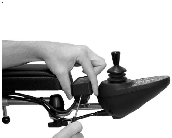
Abb. 50. Deckel des Schaltkastens abnehmen.
