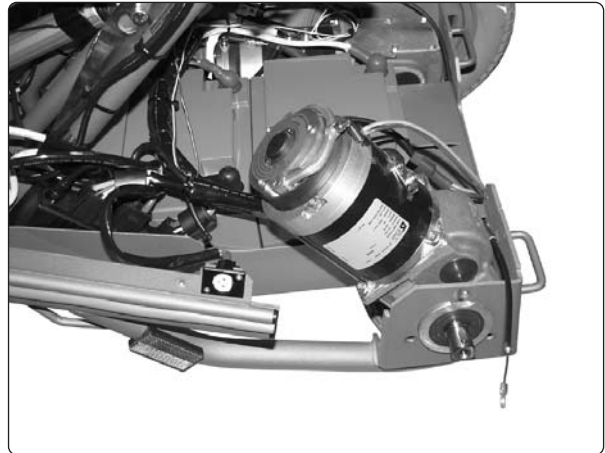
Abb. 22. Durch Hochklappen des Motors an der Hinterseite kommt man einfacher an die Magnetbremse heran.
