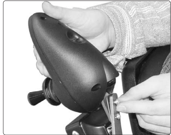
Abb. 48. Halterung von Steuerung und Schaltkasten.
