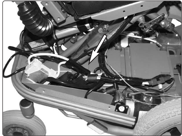
Abb. 42. Die Ausgangsstufe Pilot+ liegt lose in ihrem Halter.
