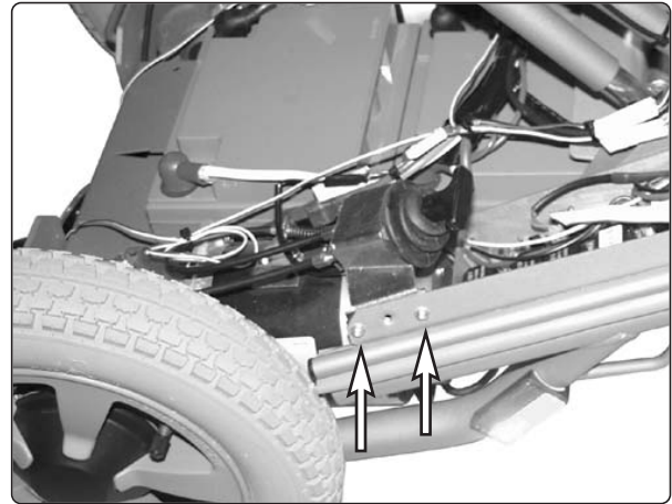
Abb. 16. Der Brementriegelungsmechanismus ist mit zwei Schrauben befestigt.
