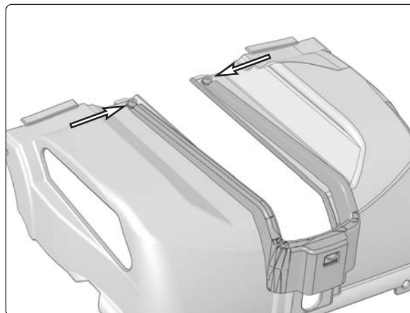
Die Abdeckung des Einklemmschutzes ist mit zwei Schrauben an der vorderen Abdeckung des Fahrgestells montiert.
