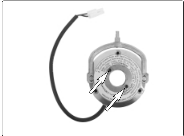
Abb. 19. Bremseinstellung anhand der beiden Einstellschrauben justieren.
