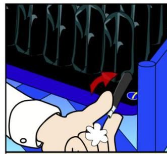
Schritt 3: Dann mit dem Pumpenschlauch das Ventil im Uhrzeiger drehen und verschließen.
