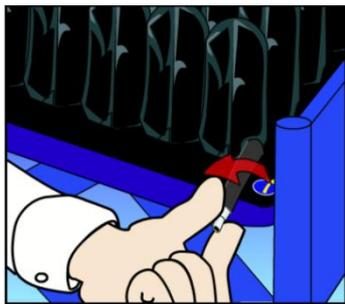
Schritt 1: Das Kissen mit Bezug in den Rollstuhl legen und sicherstellen, dass es in der Mitte platziert ist und das Ventil an der vorderen, linken Ecke liegt. Dann das Ventil auf der Seite gegen den Uhrzeiger öffnen.
