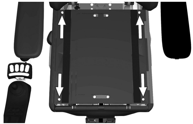
Abbildung 195. Die Sitzplatten sind mit zwei Schrauben an der Hinterkante sowie zwei Schnellverschlussklammern an der Vorderkante befestigt.
