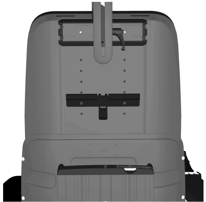
Abbildung 200. Verriegelungsmechanismus der Rückenlehne, montiert für eine Rückenlehnenhöhe von 645 mm. (26 Zoll).
