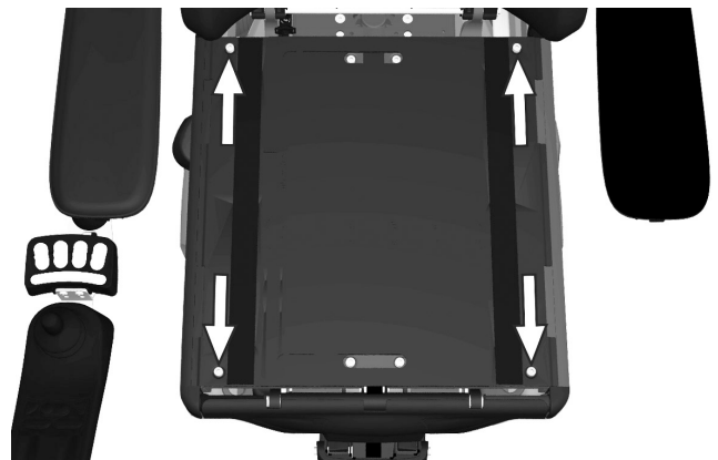
Abbildung 73. Die Sitzplatten sind mit vier Schrauben befestigt.
