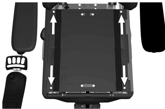
Abbildung 196. Die Sitzbleche sind mit zwei Schrauben an der Hinterkante und zwei Schnellbefestigungsclips an der Vorderkante befestigt.
