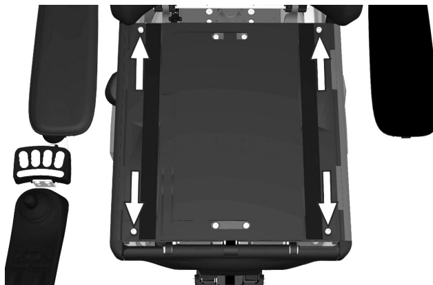
Abbildung 141. Die Sitzplatten sind mit vier Schrauben befestigt.
