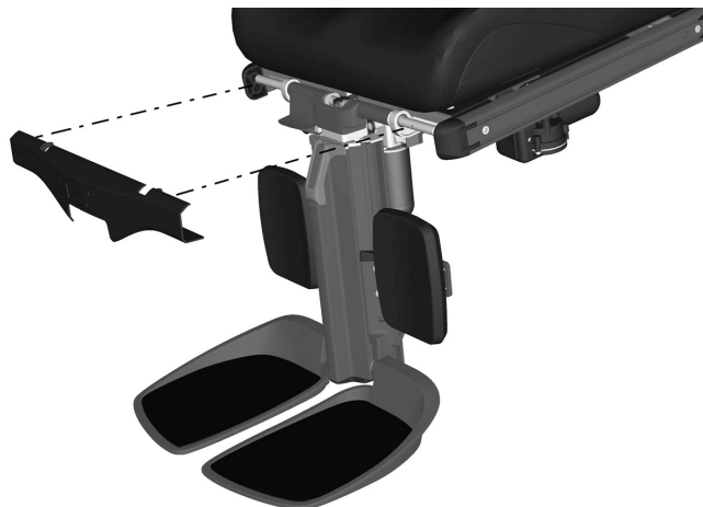
Abbildung 182. Obere Kunststoffabdeckung der Beinstütze entfernen, indem man sie gerade hochzieht.
