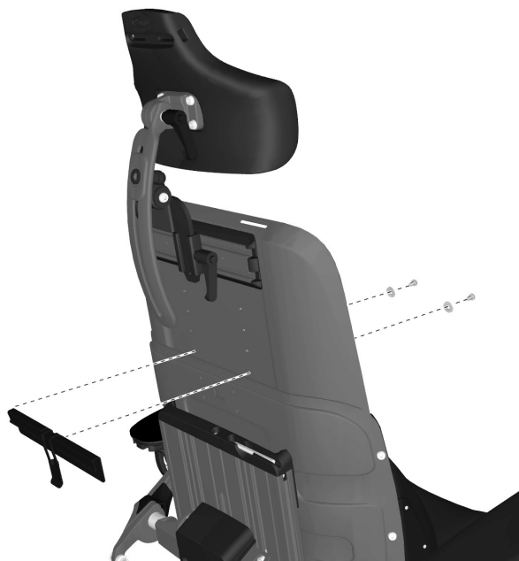
Abbildung 199. Der Verriegelungsmechanismus ist mit zwei Schrauben befestigt.
