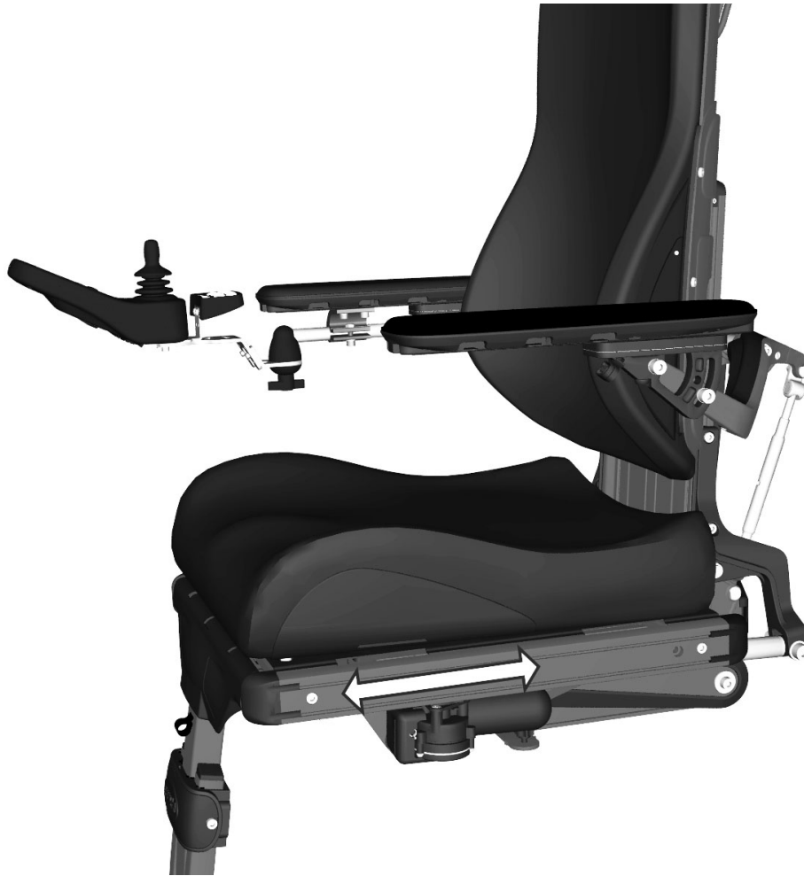
Abbildung 208. Die Position der Oberschenkelstütze kann eingestellt werden
