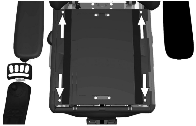
Abbildung 151. Die Sitzplatten sind mit vier Schrauben befestigt.
