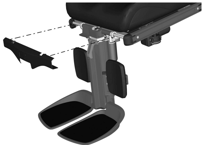
Abbildung 187. Die Halterungen der oberen Kunststoffabdeckung der Beinstütze vorsichtig auf die Befestigungsschrauben/Distanzstücke der Beinstütze drücken.
