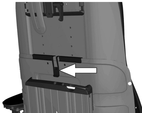
Abbildung 154. Der obere Teil der Rückenlehne ist mit einem Verriegelungsmechanismus befestigt.
