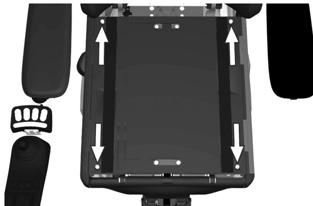
Abbildung 62. Die Sitzplatten sind mit vier Schrauben befestigt.
