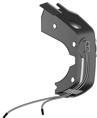
Abbildung 133. Die vorderen Blinker sind an der Abdeckung des Antriebspakets montiert.
