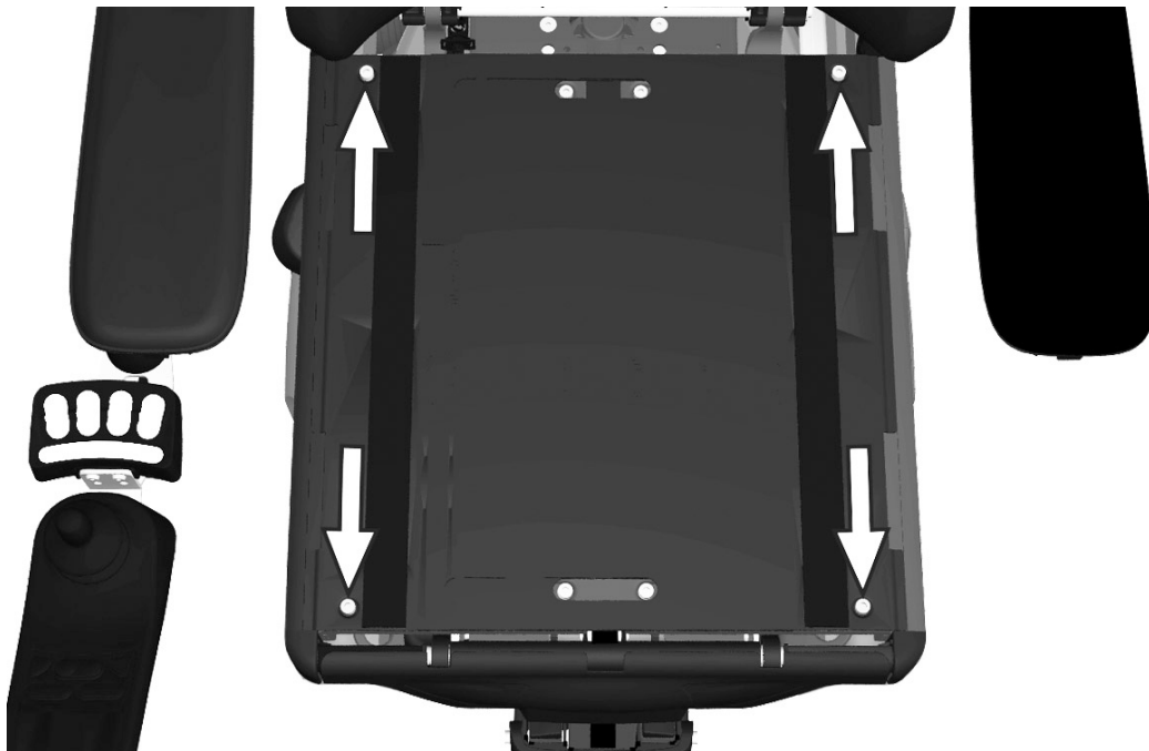
Abbildung 153. Die Sitzplatten sind mit vier Schrauben befestigt.
