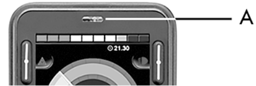
Abbildung 60. Position des IR-Empfängers.
