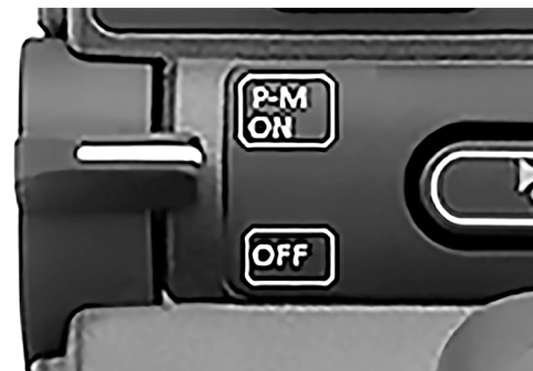
Abbildung 20. Stromversorgung, Modus und Profilhebelschalter.
