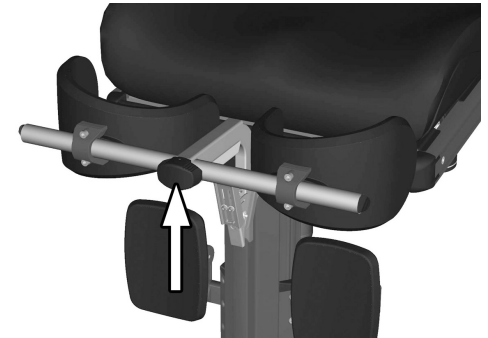
Abbildung 146. Einstellen der Tiefe der Kniestütze.
