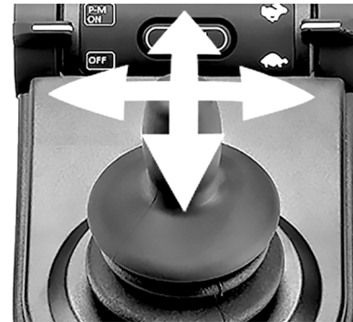
Abbildung 57. Im Bluetooth®-Modus lassen sich per Joystick die Mausfunktionen steuern.
