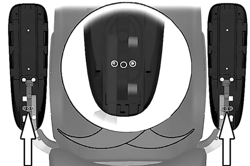
Abbildung 136. Endposition der Armlehenschwenkvorrichtung einstellen.
