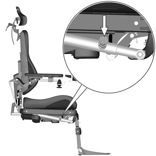
Abbildung 10. Manuelle Einstellung des Beinstützenwinkels.
