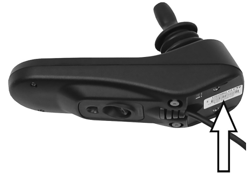
Abbildung 228. Kennnummer des Steuerpults.
