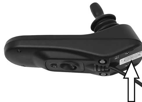
Abbildung 229. Kennnummer des Steuerpults.
