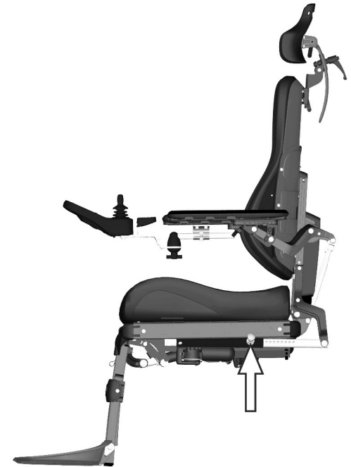
Abbildung 8. Manuelles Klemmrohr für die Rückenlehnenneigung.
