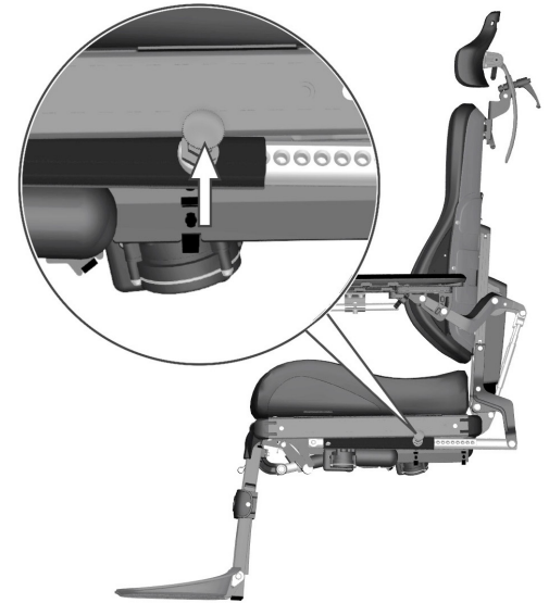
Abbildung 9. Manuelle Einstellung des Rückenlehnenwinkels.
