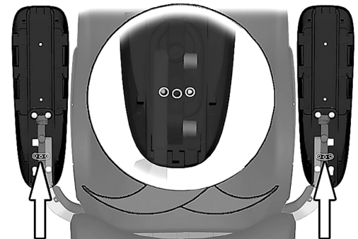
Abbildung 137. Endposition der Armlehenschwenkvorrichtung einstellen.
