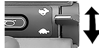
Abbildung 56. Im Bluetooth®-Modus wird der rechte Hebelschalter verwendet, um nach oben oder unten zu scrollen.
