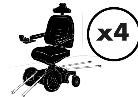
Abbildung 174. Am Rollstuhl befinden sich vier Zurrpunkte. Das Bild zeigt einen unspezifischen Rollstuhl mit Zurrpunkten.
