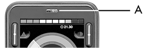
Abbildung 60. Position des IR-Empfängers.
